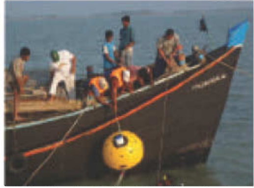
ডিপ্লমেন্ট অফ ADCP হাইড্রোগ্রাফিক ডাটা: নদীর শ্রোতের ডাটা সংগ্রহের জন্য ADCP ডিপ্লমেন্ট করা হয় কুতুবদিয়া চ্যানেলে
