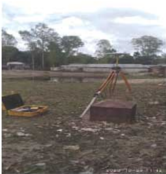
ফটো RTK বেস স্টেশনটি একটি SoB BM অফ (বায়) এবং RTK-GPS অফটা সফটওয়্যার সহিতের (অন্যন্বিত) স্থাপন করা হয়েছে
