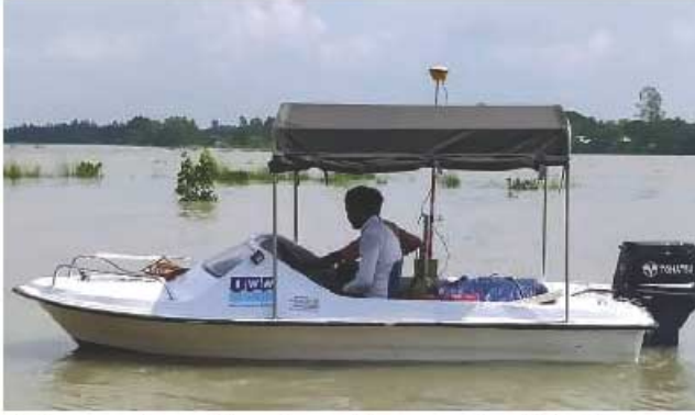
পুরাতন ব্রহ্মপুত্র ডেল্টা জাজে মোতায়েন করা ব্যাথিম্যাট্রিক সার্ভে বোট (IWM সার্ভে ভেসেল ১)
